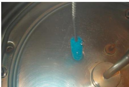
Основная очистка также включает очистку всасывающих и выпускных патрубков. После очистки тэна, внутренних стенок котла, а также всасывающих и нагнетательных отверстий Braumeister опорожняется, а весь котел снова ополаскивается.
