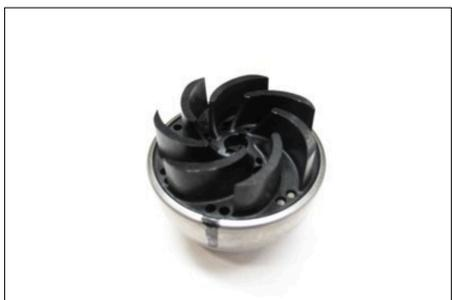
Вынуть крыльчатку насоса из корпуса для мойки. Никакие остатки варки не должны забивать отверстия крыльчатки, поэтому их следует осторожно удалить.
