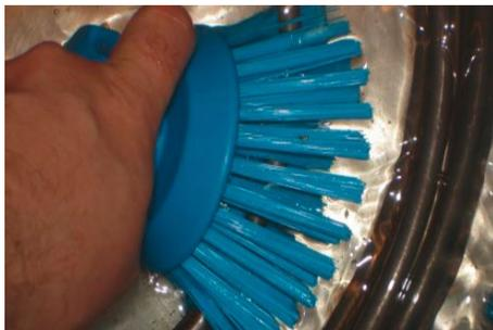
Налейте воду припл. на 2 см выше нагревательного элемента и нагрейте его вручную до ~ 35°C с помощью блока управления. Внимание: необходимо удалить воздух из насоса, включив и выключив его несколько раз! **Затем отключите Braumeister от электросети!** Теперь остатки варки можно удалять изнутри емкости и тэна с помощью щетки, предпочтительно сразу после каждой варки.
